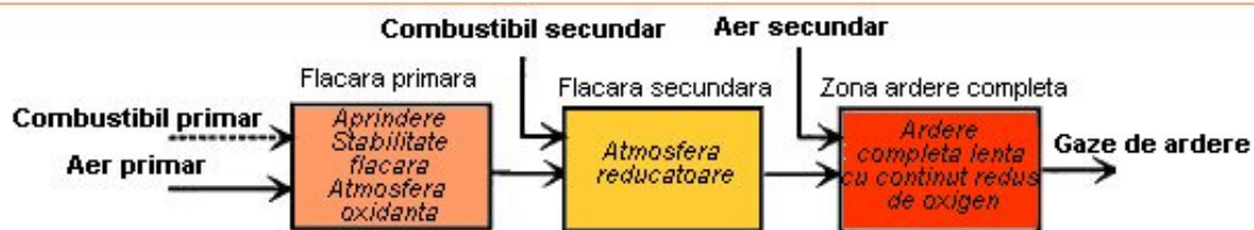
Figura nr. 5 Arzător cu formare redusă de \text{NO}_x cu introducerea în trepte a combustibilului
